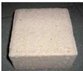
Pavés en béton poreux
