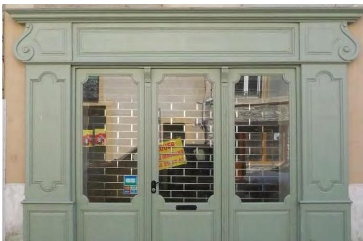
Lorsque la sécurité du local commercial nécessite un rideau roulant, celui-ci doit être placé derrière le vitrage (sauf contrainte particulière). Dans tous les cas, l'usage d'un rideau à mailles ou à lames micro-perforées permet de préserver l'attraction commerciale en évitant l'aspect « clos » des devantures aux heures de fermeture.
